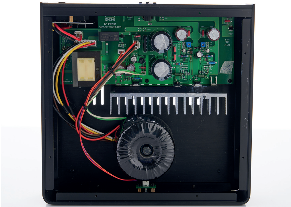
Ringkernnetztrafo, Gleichrichtung und Siebung wurden ausgelagert und in ein separates Gehäuse verbannt
